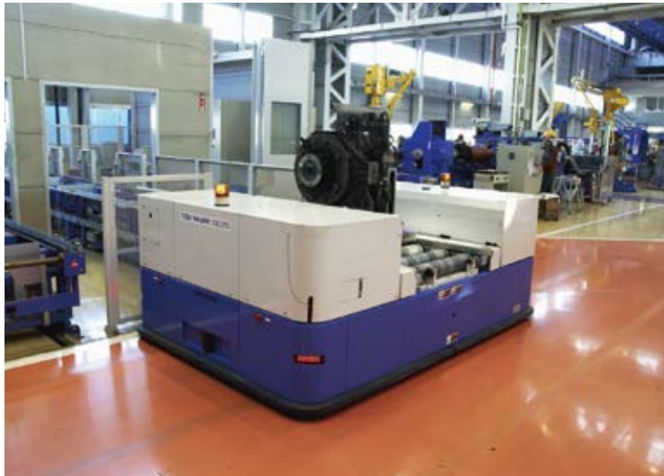
・約3tの鉄道車輛用モーターを搬送する「ムジンカーマルチ」
