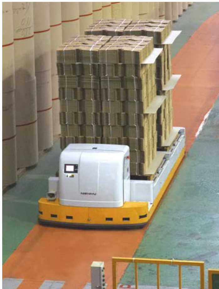
・段ボール生産工場で製品を搬送する「ムジンカー」(低床型)
