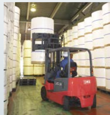
・ローテティングロールクランプ仕様「トランサー・フォルセア」
