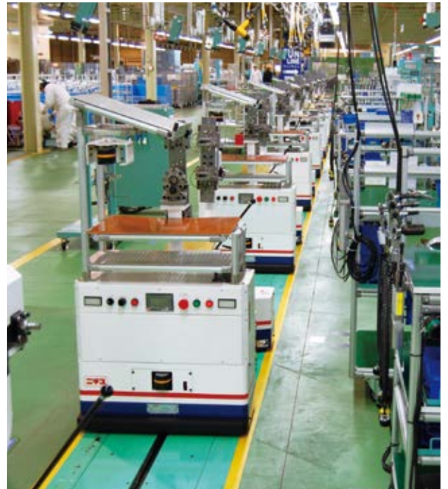
・組立ワークを搬送する有軌道式ループ台車
