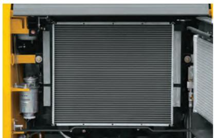
ラジエーターおよびオイルクーラーの大型化により、冷却性能が向上。ラジエーター水温を従来車より約12%低減したほか、HST油温も低減しています。
