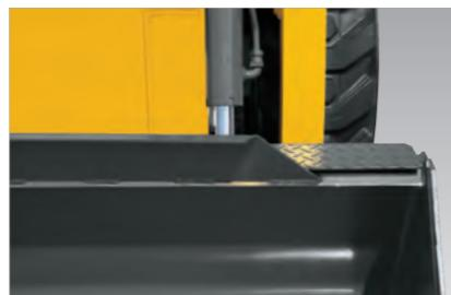
パケットシリンダーへの荷こぼれがかかりにくい位置へレイアウト変更に加え、キャップシール構造を改良することで、異物混入による油圧回路を保護し、信頼性を向上しました。
