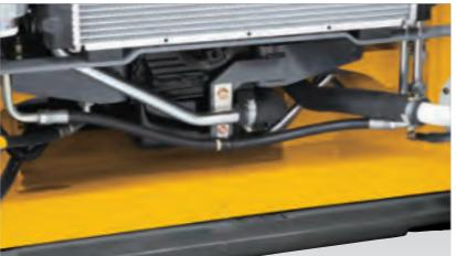
フロアボードのペダル下とアンダーカバーにゴミ排出口を追加。車体底面に配管を設置しないことで、車体清掃の容易化を図っています。また、ブームサイドの形状変更、荷役装置のピン取り付け構造を変更し、ゴミがたまりにくい構造としています。
