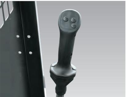
ウィンカーをボタン式に、アタッチメントハンドコントロール(オプション)をシーソースイッチに変更し、操作性を改善しました。また、エンジン取付方法の改良により、走行レバーに伝わる振動を従来車に比べて約1/4に低減し、オペレーターの疲労低減を実現しています。
