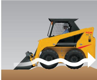
荷役フロートスイッチを押しながらブームを下降させると、ペダル操作をしなくともバケットが路面の凹凸に対して自由に動き、地ならしや牛舎の清掃などの作業を容易化する機能を装備しています。
