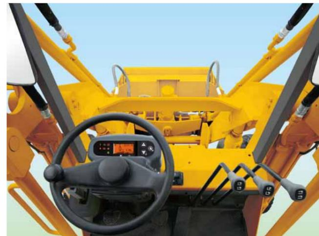
ストレスのない操作を可能にするレバー類の配置、視認性に優れた多機能液晶メーターパネルなど、荷役作業から走行時まで、使いやすさを追求したコックピットです。
