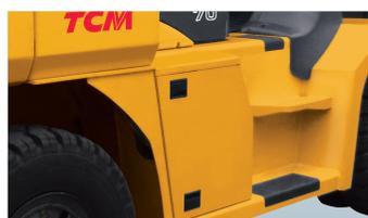
DOC・DPFマフラーを右側ステップの後方に移設し、点検カバーを設置。点検・整備も容易です。
