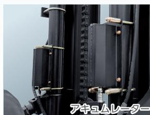
路面からの振動、衝撃によるリフトシリンダー圧力変動を高圧用、低圧用2つのアクキュレーターで吸収し緩和。騒音と衝撃を低減する、オペレーターにも、現場・周辺環境にも、積荷にもやさしい、当社独自システムのオプション装備です。
