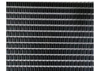
フィンピッチが広く、細かいゴミが詰まりにくい構造です。清掃性も良く長時間にわたって冷却性能を維持します。
