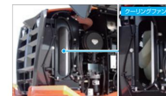
定期的なクーリングファンを自動で逆回転させ、ラジエータについたゴミを吹き飛ばしラジエータの汚れを軽減します。清掃時は閉鎖式のクーリングファンを開いて、エアブローによる清掃が容易に行えます。
