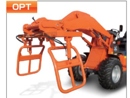
曲線アーム形状により、ラッピングロールを傷付けることなくスピーディーに運搬できます。
