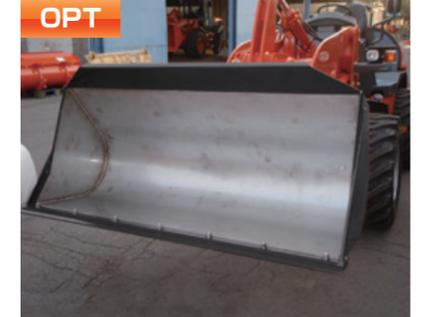
耐食性に優れたステンレス鋼をバケットの内側に張り付けたバケットです。粘着性の高い扱ひ物の荷離れ効果も期待できます。
