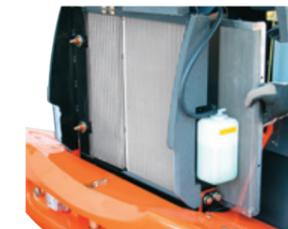
大きなゴミによる目詰まりを防止するためのスクリーンです。スクリーンは容易に脱着でき、キャッチしたゴミを簡単に取り除くことが可能です。
