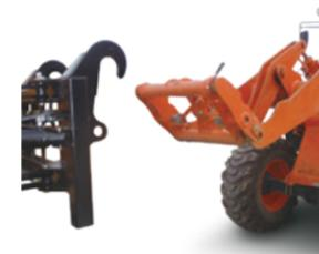
アタッチメントの交換を容易にする装置です。手動式と油圧式から選択できます。
