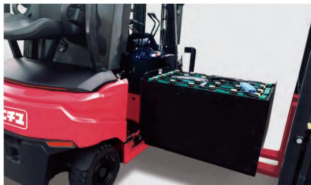
バッテリーメンテナンス作業を大幅に効率アップする
